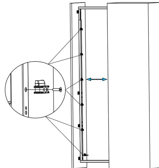
6) Colocar las canastillas y fijar con las cubiertas para canastillas en ambos lados (las canastillas de piso melaminico no llevan cubiertas).
