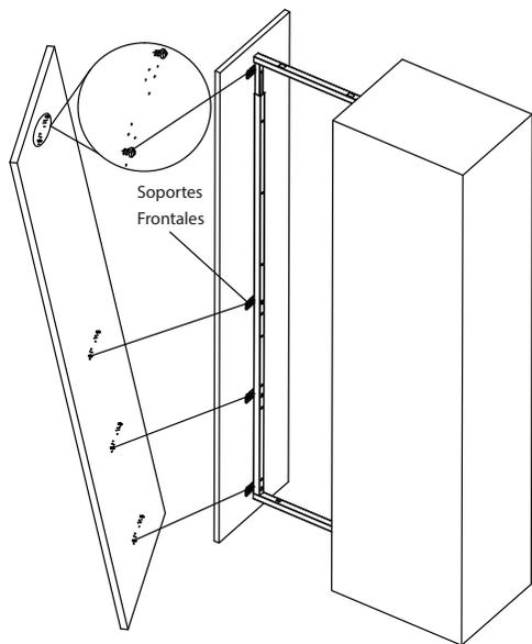
5) Fijar los soportes para canastilla en el marco, según la posición deseada.
