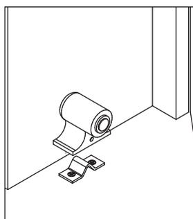
4) Colocar el tope sobre la placa de fijación.
