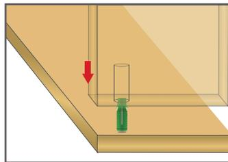
2) Empujar manualmente el lateral del mueble sobre el perno PAD.
