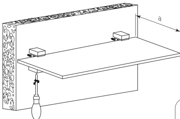
3) Colocar la repisa y girar nuevamente el tornillos en la parte inferior de la ménsula para ajustar según el espesor de esta.
