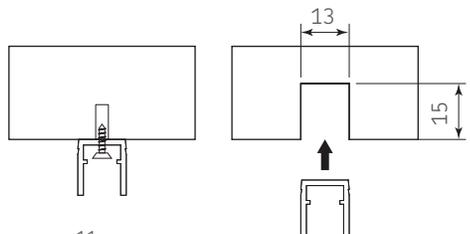
Ensamble de riel superior, realizando una perforación de 15 x 13 al panel superior.
