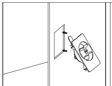
Inclinar la cerradura para ensamblar en la perforación realizada en la puerta del mueble.
