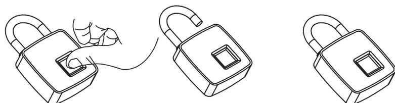
Después de registrar la o las huellas digital (ver instructivo de instalación II-0201-128), colocar el dedo sobre el sensor para huella digital, para abrir el candado
