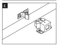
c) Verificar que la contra y el forzador queden alineados para un adecuado funcionamiento
