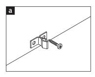
a) Fijar la contra a la puerta del mueble con los tornillos cuidando la alineación con el forzador
