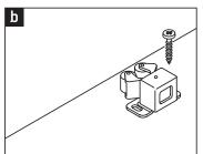
b) Fijar el forzador al piso o techo del mueble con los tornillos
