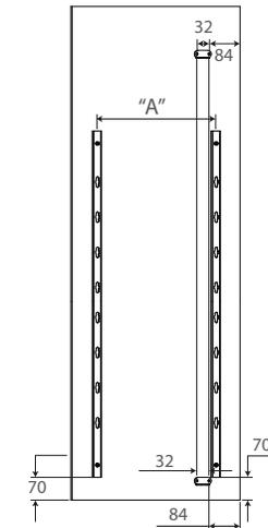
Colocar las barras de conexión con la puerta, el marco y la base.
