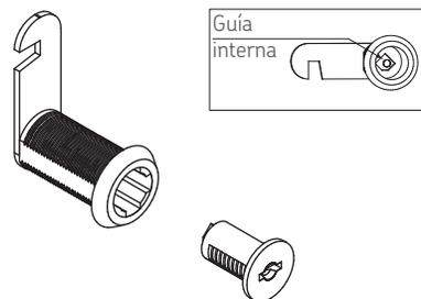
**b)** Empujar ligeramente el cilindro dentro del mecanismo hasta escuchar un click.
