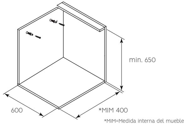
**NOTA:** Asegurese de que el gabinete haya sido fijado a la pared antes de colocar el columpio porta garrafón. (tornillos y taques para pared no incluidos)
