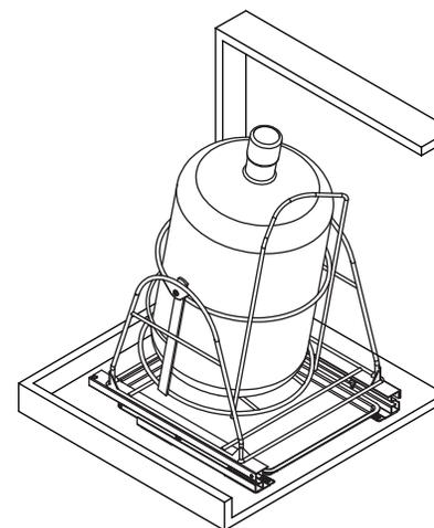
**Paso 2:** Extender las correderas y deslizar el columpio porta garrafón hasta topar con las pestañas posteriores y fijar con los tornillos ya incluidos.
