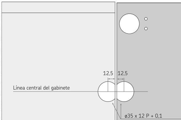
Colocar la tapa de la cubierta en el sistema de apertura central del lado de la puerta como se muestra en la siguiente imagen y después fijarlo al gabinete.
