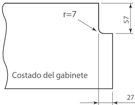
Utilizando el soporte para perfil 1209-089 fijar el perfil gola 1209-018 / 1209-027 a los costados del gabinete.
