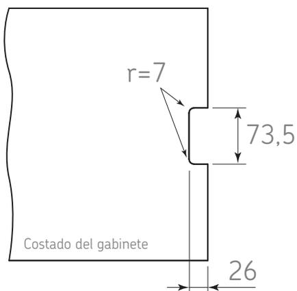
Utilizando el soporte para perfil 0701-827 fijar el perfil gola 1209-019 / 1209-028 en ambos costados del gabinete.
