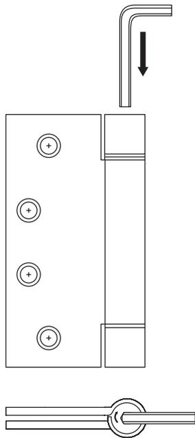
a) Insertar la llave allen en agujero superior de la bisagra y presionar hasta que la bisagra pueda abrirse.
