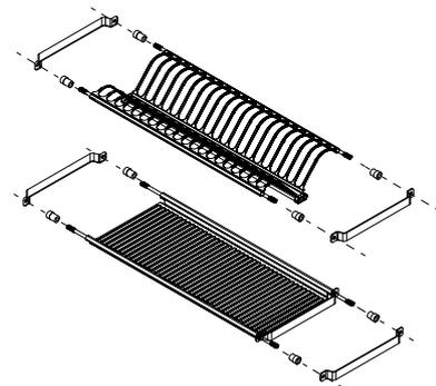
Paso 3: Colocar los soportes y fijar con las tuercas, en ambos lados.
