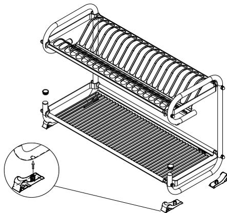
Paso 5: Deslizar la charola en la bandeja hasta enganchar, enseguida colocar el porta cubiertos.
