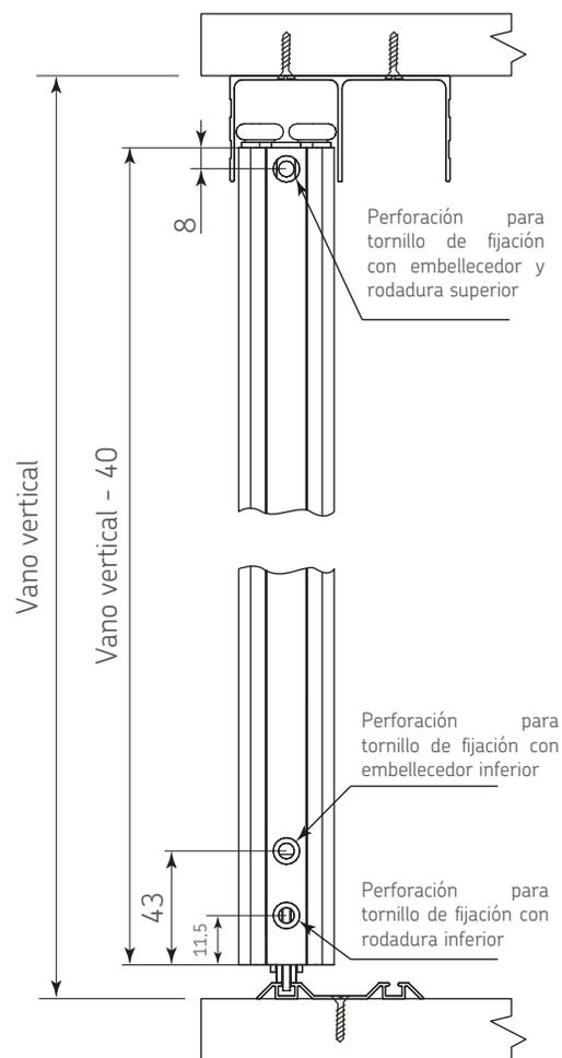
Para colocar el tornillo de fijación realizar una perforación pasada de  $\varnothing 6$  y agrandar a  $\varnothing 10$  la perforación del lado exterior del perfil tirador.
