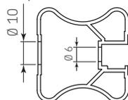
Fijación perfil tirador con embellecedor superior y guía
