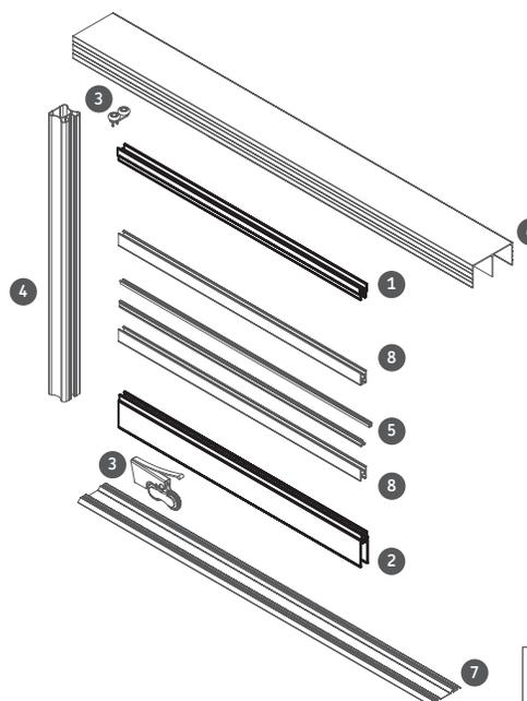
Colocación de cople 1103-189 y empaque U 0701-063 para aplicación con cristal 4mm
