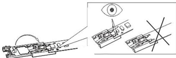
1) Colocar el tramo de tira led por debajo de las placas metálicas de la caja plástica del cable de alimentación o conector.
