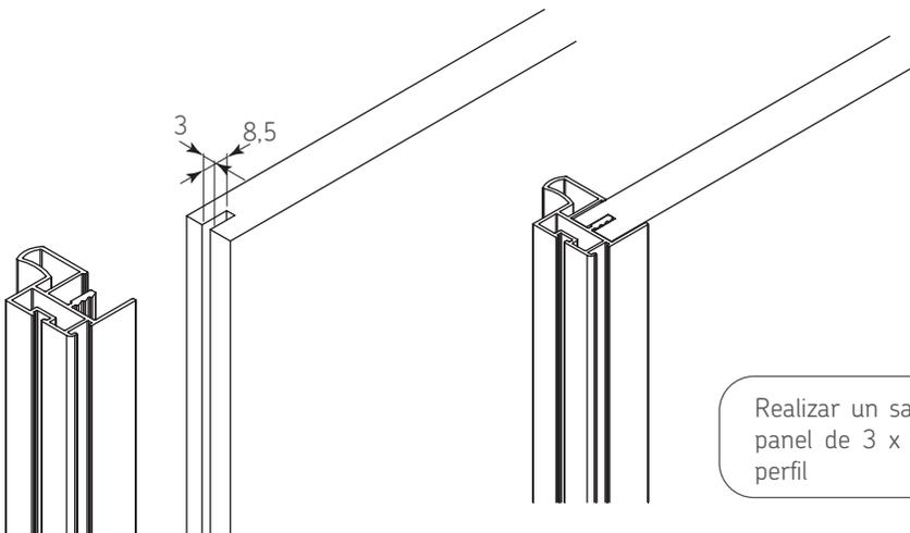
Realizar un saque a ambos lados del panel de 3 x 8,5, para ensamblar el perfil
