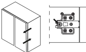
b) Una vez realizados los ajuste fijar la base con los tornillos 1.
