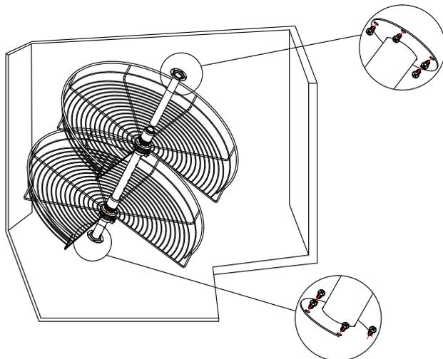
Paso 2: Colocar las canastillas a la altura deseada y fijar con los soportes para canastillas y los pernos (ya incluidos).
