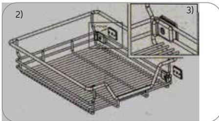
Insertar las conexiones de esquina dentro de la canastilla y fijarlos con los espaciadores. Utilizar el espaciador de acuerdo al ancho del panel (Figura A).
