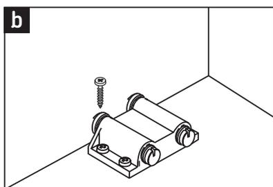
b) Fijar el broche al piso o techo del mueble con los tornillos
