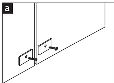
a) Fijar la contra a la puerta del mueble con los tornillos cuidando la alineación con el forzador
