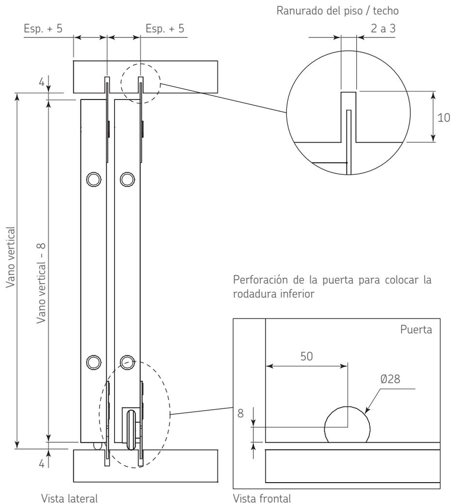
Perforación de la puerta para colocar la rodadura inferior
