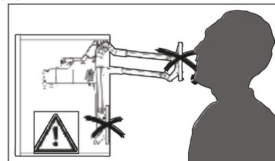
No bajar el brazo del mecanismo antes de ensamblar las puertas, ya que puede dañar el brazo o sufrir alguna lesión
