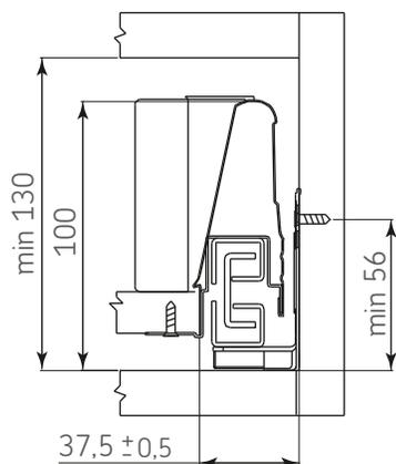
Dimensiones de ensamble del soporte para testero:
