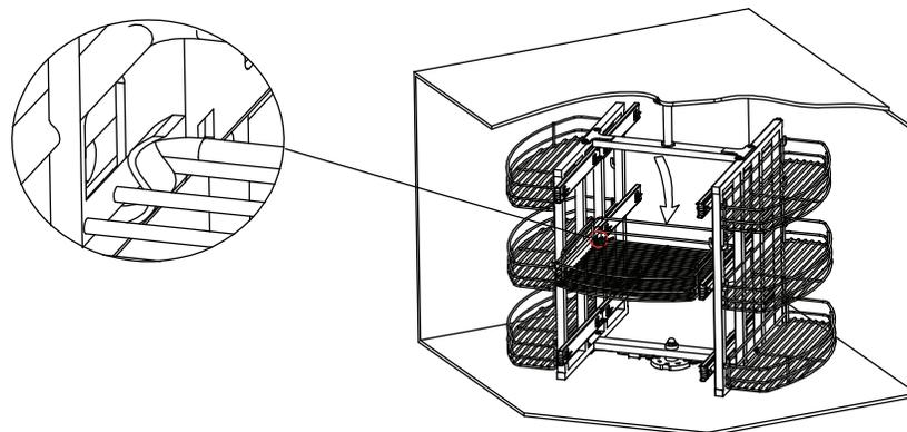
Colgar las canastillas "V" del lado contrario en el que se colocaron las canastillas "D".
