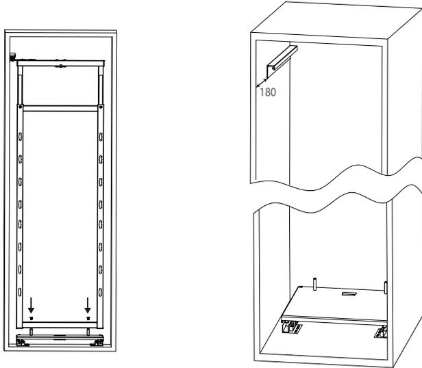
4) Colocar los soportes frontales de las barras de conexión a la puerta con los tornillos 4x16 (ya incluidos).
