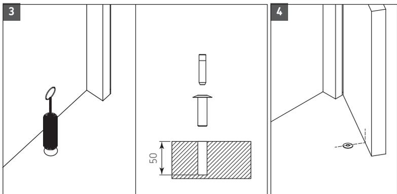
**3)** Con ayuda del cepillo limpiar la perforación realizada al piso, colocar un poco de silicón en la perforación y posteriormente colocar el sujetador y el perno.
