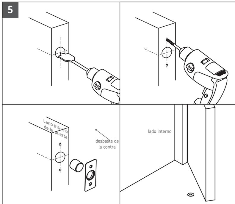
**5)** Desmontar la puerta, realizar la perforación para la colación del imán utilizando las brocas de manita del kit de herramientas 0102-271, siguiendo la línea marcada en la cara interna de la puerta.
