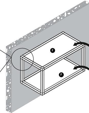
NOTA: Los paneles pueden ser fijados mediante tornillo o pegamento, según el requerimiento del cliente.
