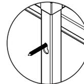
Deslizar la estantería hacia abajo hasta que tope el tornillo con la perforación más chica de la bocallave, para evitar que el tornillo salga de la perforación de la estantería.
