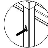
Una vez puesto el tornillo al muro, hacer coincidir la cabeza del tornillo con la apertura más grande de la bocallave, hasta que entre correctamente en ella.
