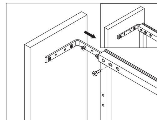
Los tornillos de ajuste (2) deben quedar dentro del marco extraíble.
