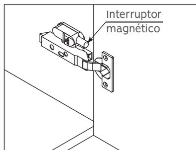
3) Fijar la lámpara en el cuerpo de la bisagra por el interior del gabinete mediante el imán de fijación.
