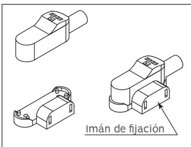
2) Colocar nuevamente la lámpara en la base aplicando una ligera presión, hasta que los pines entren en su posición.
