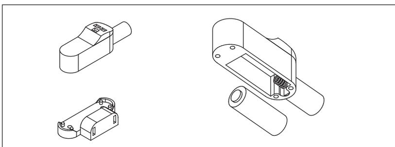
1) Retirar el cuerpo de la lámpara de la base y colocar la batería, teniendo cuidado en seguir correctamente la polaridad indicada en esta.
