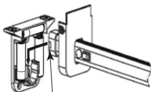
Polos de conexión (no retirar la cubierta)
