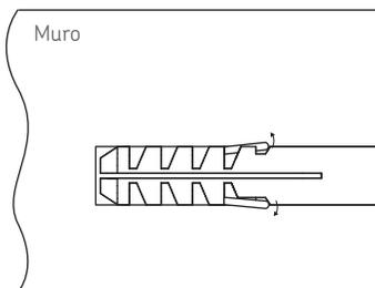
3) Entra el tornillo en el taque formando una cuerda dentro de el y comprime el taquete dentro del muro favoreciendo su anclaje.
