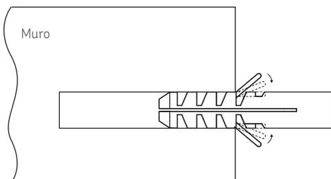
2) Dentro del muro las pestañas de sujeción anclan el taquete al muro.
