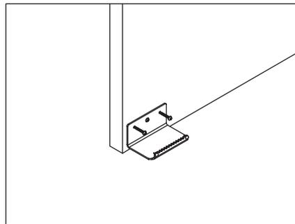
d) Fijar la jaladera para pie con los tornillos laterales.
