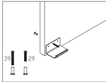
b) Realizar una perforación pasada en la puerta, para colocar el tornillo de bloqueo.
