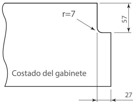
Utilizando el soporte para perfil 1209-089 fijar el perfil gola 1209-073 / 1209-081 / 1209-090 / 1209-094 a los costados del gabinete.
