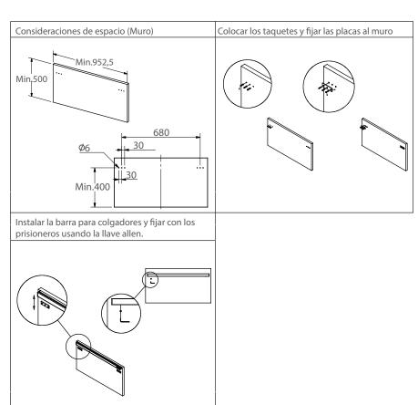
2) Colocar los colgadores en la barra, inclinándolos ligeramente hasta enganchar la parte superior del colgador a la ranura posterior de la barra
