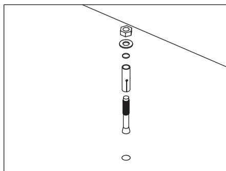
1) Realizar una perforación en el piso de  $\varnothing 12,5$ . Colocar el tornillo con taquete expansivo como se muestra en la imagen.
