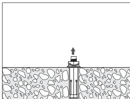
2) Con ayuda de una llave girar la tuerca hasta expandir el taquete y subir el tornillo para colocar el tope.
