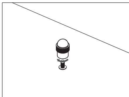
3) Retirar la tuerca y colocar el tope girandolo sobre el tornillo en sentido de las manecillas del reloj hasta topar.
