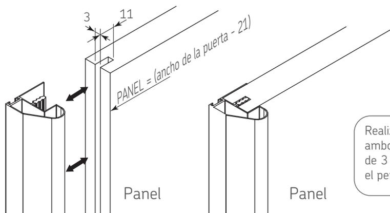
Realizar un saque en ambos lados de la puerta de 3 x 11, para ensamblar el perfil.
