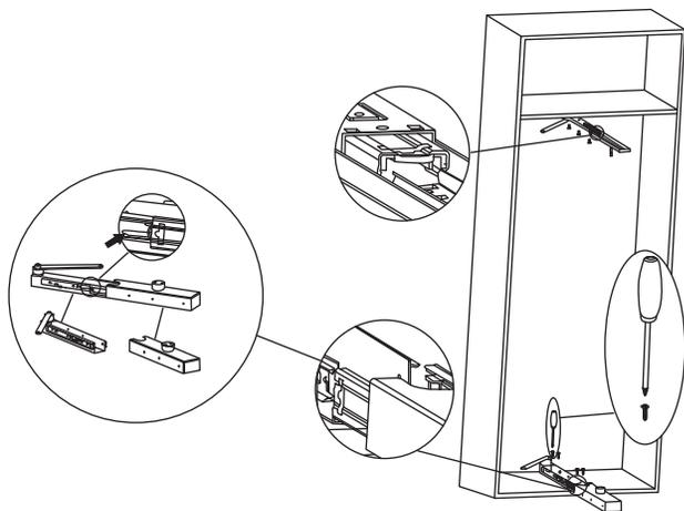
2) Instalar la jaladera, colo car el marco en las correderas y ajustar la altura
