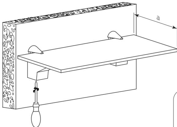
3) Colocar la repisa y girar nuevamente el tornillos en la parte inferior de la ménsula para ajustar según el espesor de esta.
