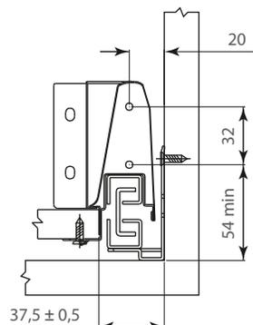
Dimensiones de ensamble del soporte para testero
