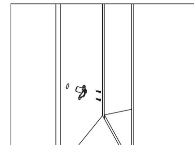
2) Realizar una perforación a la puerta del mueble de  $\varnothing 16,5$ , colocar la cerradura y fijarla con los tornillos incluidos.
