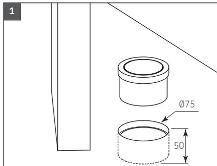
1) Realizar una perforación en el piso de  $\varnothing 75$  y 50 de profundidad. Colocar el tope para piso.
