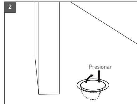
2) Una vez colocado el tope en el piso presionar un extremo para girarlo.
