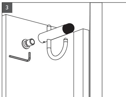
3) Colocar el tope en la base fijada al muro y girar nuevamente el prisionero para sujetar el tope a la base.
