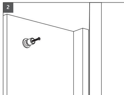
2) Fijar la base del tope al muro con el tornillo Ø4x44,5 (ya incluido).
