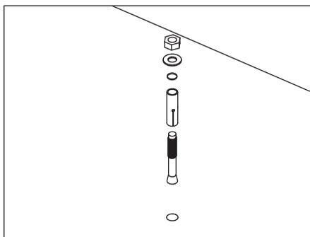
1) Realizar una perforación en el piso de  $\varnothing 12,5$ . Colocar el tornillo con taquete expansivo como se muestra en la imagen.
