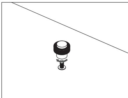
3) Retriar la tuerca y colocar el tope girandolo sobre el tornillo en sentido de las manecillas del reloj hasta topar.
