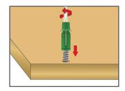
1) Colocar el Perno PAD en la perforación de Ø5 con ayuda de un desarmador de cruz.
