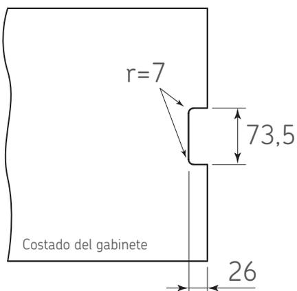
Utilizando el soporte para perfil 1209-089 fijar el perfil gola 1209-074 / 1209-082 / 1209-091 / 1209-095 en ambos costados del gabinete.
