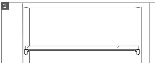
**1** Con el tornillo fijar la mensula en la perforación realizada al lateral del mueble sin apretarla totalmente y colocar el cristal sobre las mensulas
