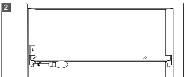
**2** Insertar el soporte superior de la mensula, ajustar al espesor del cristal y fijar girando el tornillo.
